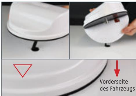
6. Führen Sie die Kabel durch die Öffnung und entfernen Sie die selbstklebende Rückseite des 3M-Montagepads. Führen Sie die Kabel durch die Dachöffnung und richten Sie die Antenne so aus, dass der aufgeprägte Pfeil zur Vorderseite des Fahrzeugs zeigt. Die Außenränder der Antenne müssen dabei an der vorher angebrachten Markierung ausgerichtet werden.
