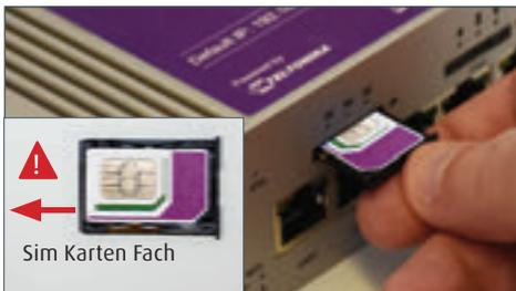
4. Setzen Sie das SIM-Kartenfach wieder in den Router ein. Der Metall Chip sollte immer noch nach oben zeigen und der SIM-Text auf der Vorderseite des Sim-Kartenhalters sollte richtig herum stehen. Das Fach sollte sich ohne Widerstand in den Steckplatz schieben lassen, bis er vollständig eingeschoben ist.
