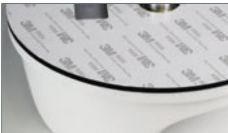
1. Das 3M-Montagepad ermöglicht eine dauerhafte Installation. Die Haftung des Montagepads ist äußerst stark und die Antenne ist nicht dafür konzipiert, abgenommen zu werden. Bitte vergewissern Sie sich, dass Sie mit der Position und Ausrichtung der Antenne zufrieden sind, bevor Sie die Antenne aufkleben.
