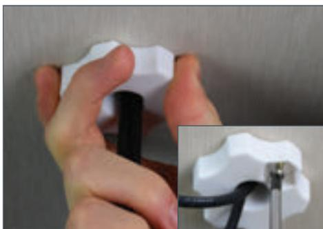
8. Befestigen Sie die Hohlschraube im Fahrzeuginneren und ziehen Sie sie gegen den Uhrzeigersinn am Schraubgewinde fest, das aus der Unterseite der Antenne hervorragt. Drehen Sie so lange, bis die Hohlschraube das Montagepad zusammendrückt.
